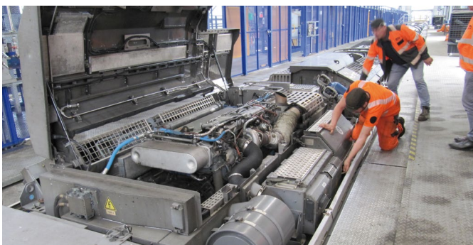
Groupe électrogène en toiture - Moteur MAN de 460 Kw
