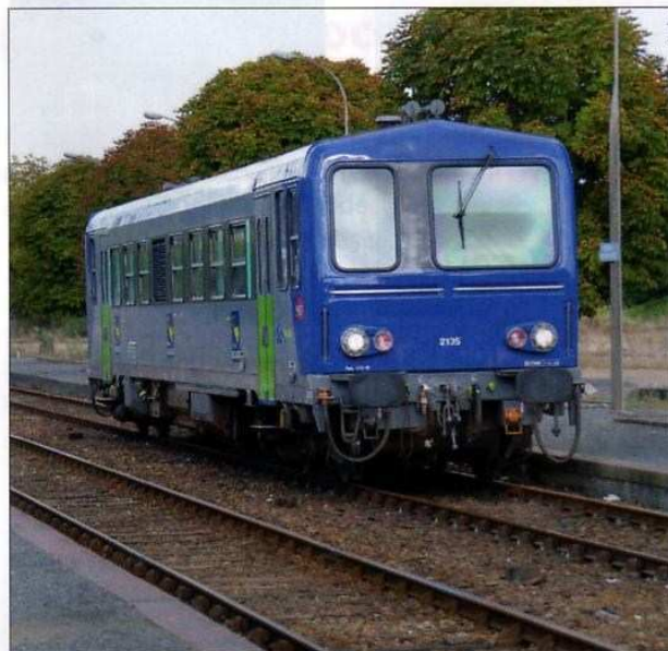
Un X 2100 assurant un TER estival Transbaie à Pontorson, où l'on note l'état fatigué des deux voies principales (27 août 2009).
