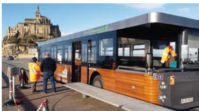
Navette relookée et roulant avec un biocarburant (HVO) produit à partir d'huiles alimentaires recyclées (photo Jean-Yves COLAS)
