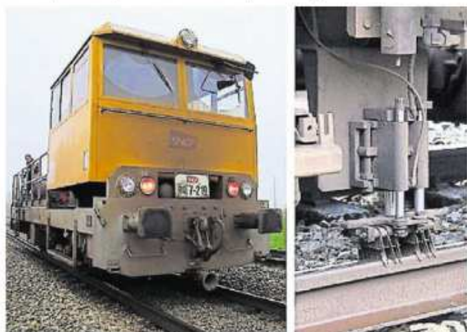
Les brosses du train laveur frottent le rail pour retirer la pâte végétale laissée par les feuilles, pour éviter le patinage.
